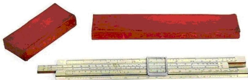
Рис. 4. Логарифмическая линейка.
